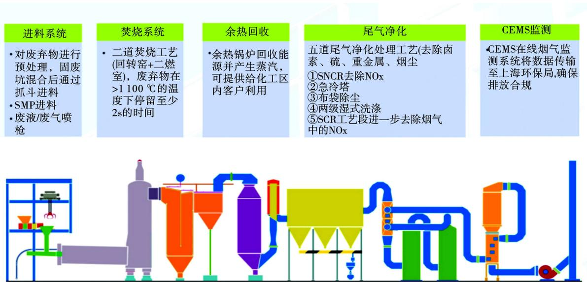
图 2 上海化学工业区环境科技公司焚烧线工艺路线
