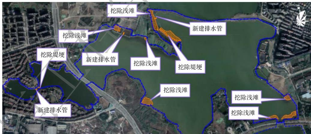
图5 挖除浅滩以及新建排水管位置
