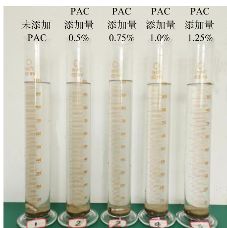
图2 粒径 >74\ \mu\text{m} 的泥沙颗粒絮凝沉降5 min时的效果
