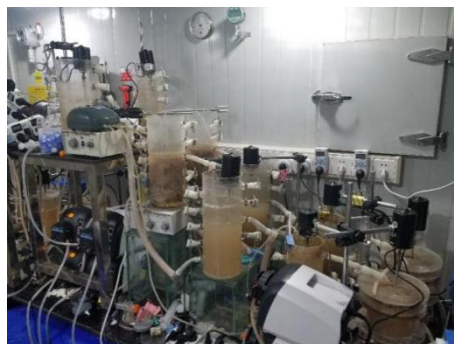
图 2 改良型双污泥除磷脱氮工艺实验装置实物图
