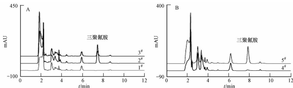
图 4 色谱图 (A. 奶粉 1<sup>#</sup>—3<sup>#</sup>; B. 液体奶 4<sup>#</sup> 和 5<sup>#</sup>)
