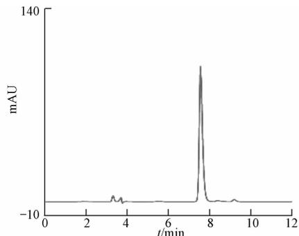
图 2 5 次 20 µg·mL<sup>-1</sup>三聚氰胺标准溶液连续进样重叠图
