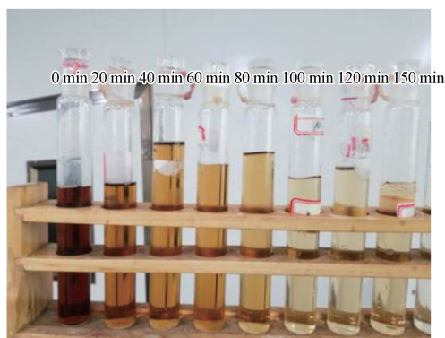
图 3 电化学氧化处理垃圾渗滤液 RO 浓缩液脱色效果
